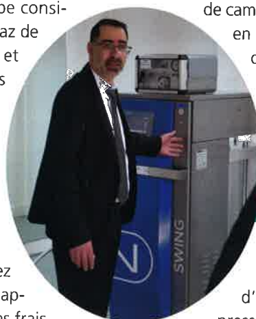
Générateur d'azote modulaire permettant d'adapter le nombre d'unités de génération aux besoins de production.
